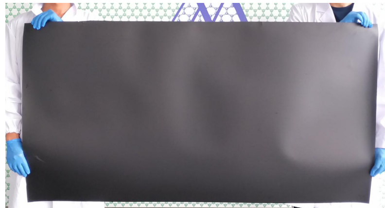
超厚氧化石墨烯原膜（最大厚度2mm）
